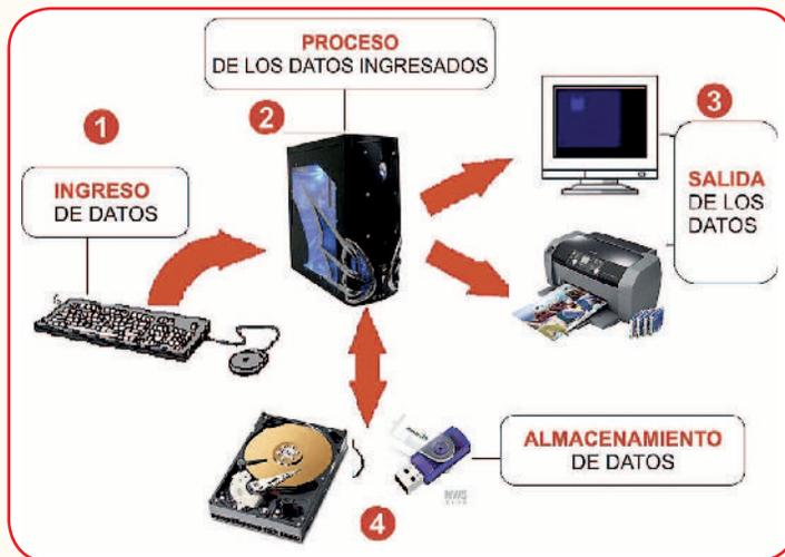
**2** El microprocesador procesa los datos y se “comunica” con la tarjeta de video “indicarle” que el cursor debe desplazarse sobre el ambiente gráfico en la distancia y la dirección seleccionadas por el usuario; de esta forma, el movimiento el cursor finalmente se realiza en la pantalla.
