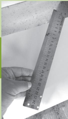
Las reglas metálicas son instrumentos que poseen escalas graduadas tanto en el sistema métrico, como en el inglés. Para el presente caso sirven como instrumentos auxiliares de trazado de líneas, mediante el concurso de rayadores.
